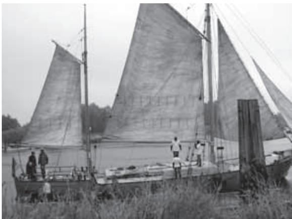
Der Frachtensegler „Melpomene von Stöckte“, ein 20 Meter langes Plattbodenschiff mit zwei Masten.
