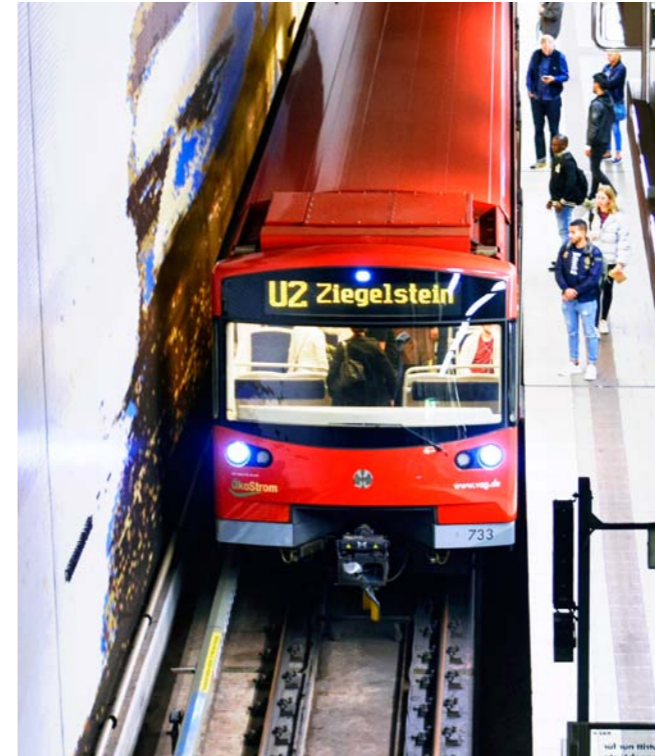
In Nürnberg fährt die U-Bahn auf den Linien U2 und U3 seit 2008 ohne Fahrer.
